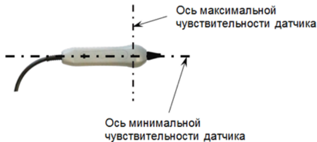
Рисунок А.2. Оси чувствительности датчика MED-127.
