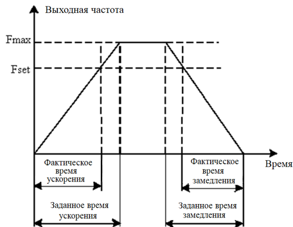
Рис. 6-2 Схема времени ускорения/замедления
