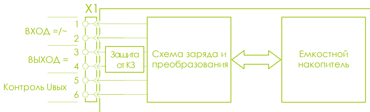
Рисунок 3.1 – Внешние цепи и внутренняя структура блока
