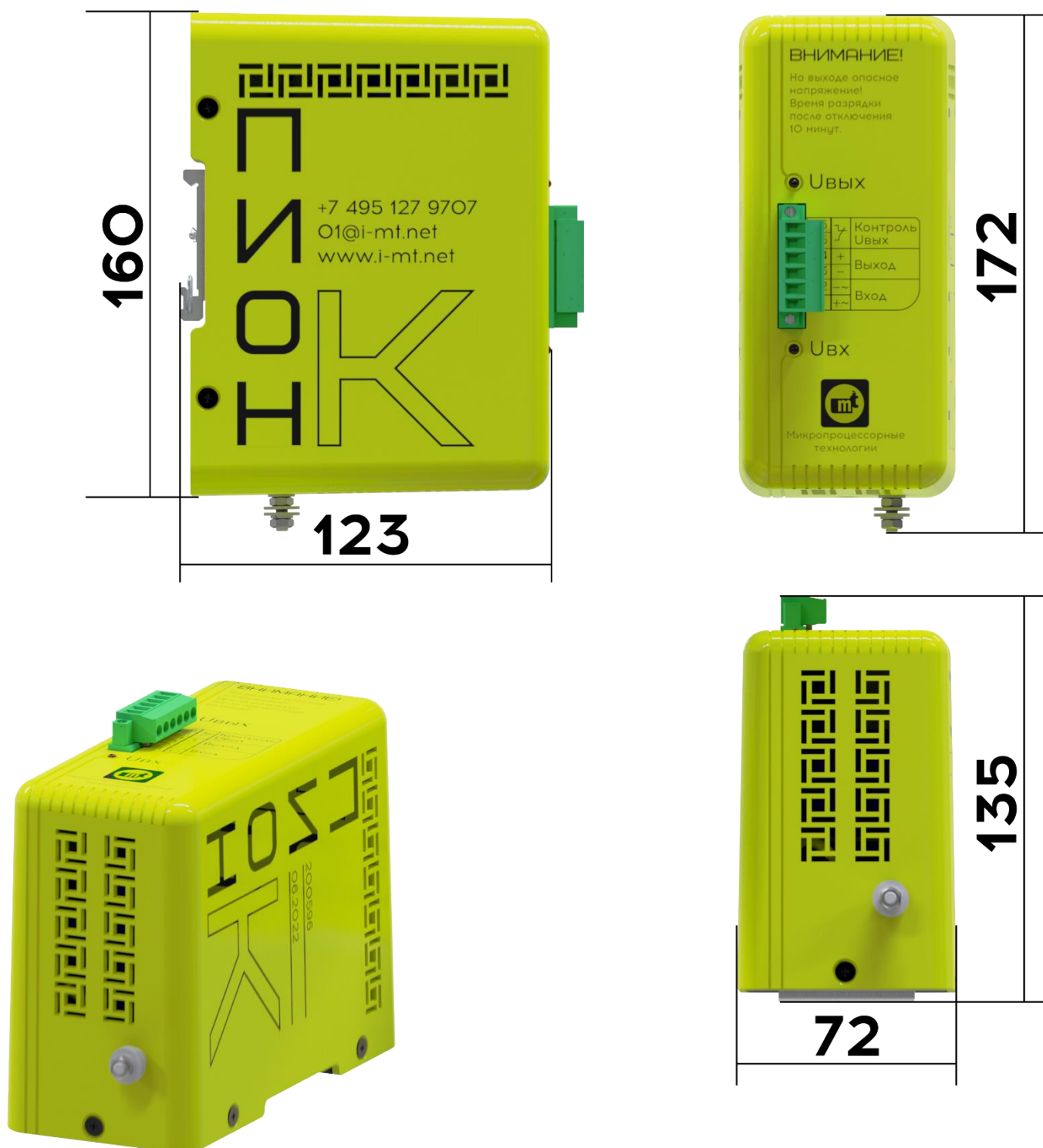
Рисунок 5.1 – Габаритные размеры Пион-К
