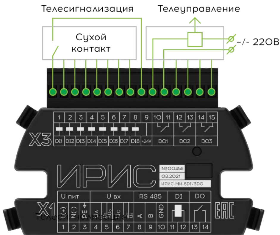
Рисунок 12.6 - Схема подключения рюкзак ИРИС - 8DI/3DO
