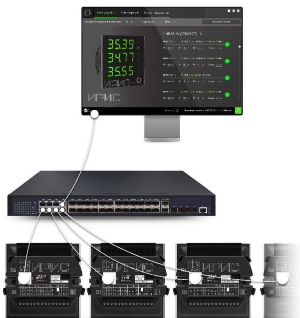
Рисунок 12.4 – Схема организации сети Ethernet
