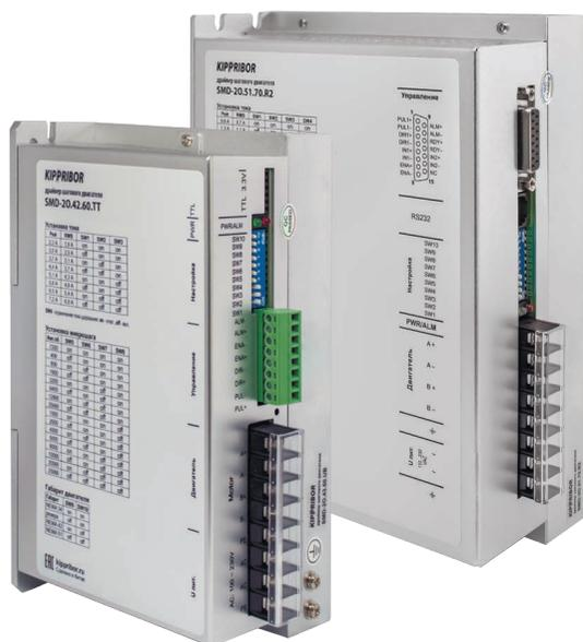
Драйверы KIPPRIBOR серии SMD предназначены для управления шаговыми двигателями. Драйвер позволяет интерпретировать команды контроллера в последовательность коммутационных состояний выходных элементов, питающих обмотки шагового двигателя. Таким образом происходит преобразование команд контроллера во вращательное движение ротора двигателя, причем параметры преобразования четко заданы драйвером с учетом характеристик подключенного двигателя.
