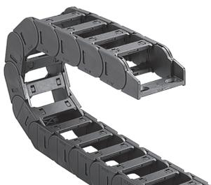
**Открытый кабель-канал** весит меньше других и лучше проветривается, а, следовательно, и кабель в нем охлаждается лучше. Его удобно монтировать и диагностировать в нем состояние кабеля. Открытый кабель-канал больше подойдет для помещений с низким уровнем пыли, грязи и других факторов производственной среды.
