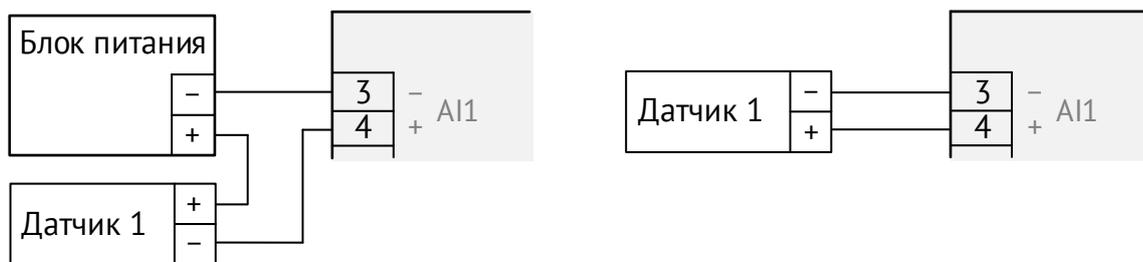
Рисунок А.27. Подключение пассивного токового датчика (слева) и активного датчика тока/напряжения (справа) к ЭНМВ-1
